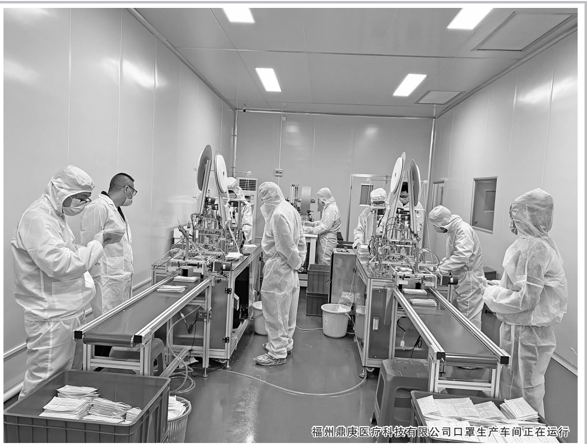
福州鼎康医疗科技有限公司口罩生产车间正在运行
